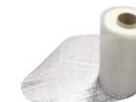
Trame de verre tissée. Cette trame est à coller au dernier rang avant de couler un plancher (excepté en cas de rupteur)
