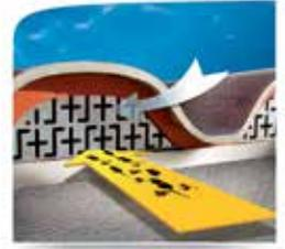
PROTEGE COMBLES est un closoir dit d'égout ou de bas de pentes destiné aux toitures réalisées à l'aide de plaques sous tuiles des marques suivantes : **ETERNIT** : Soutuile 230 FR natura et maxisoutuile. / **EDILFIBRO** : Tegolit PKF 235
