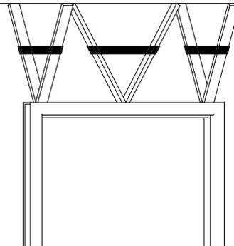
Vérifier l'aplomb des montants et le niveau de la traverse haute. Effectuer le réglage à l'aide des croisillons
