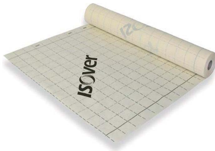
Film pare-vapeur en polypropylène armé d'un voile non tissé dont la résistance à la diffusion de la vapeur d'eau (Sd) est supérieure à 18 m. Elle est quadrillée pour faciliter la découpe et la mise en œuvre.
