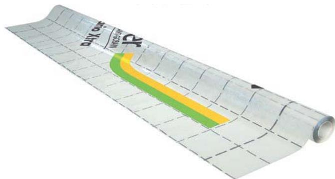
Membrane composée d'un film quadrillé à base de polymère contrecollé sur un voile non tissé, dont la résistance à la diffusion de la vapeur d'eau (Sd) varie en fonction de l'humidité relative, entre 0,4 m et 25 m. Elle est quadrillée pour faciliter la découpe et la mise en œuvre.
