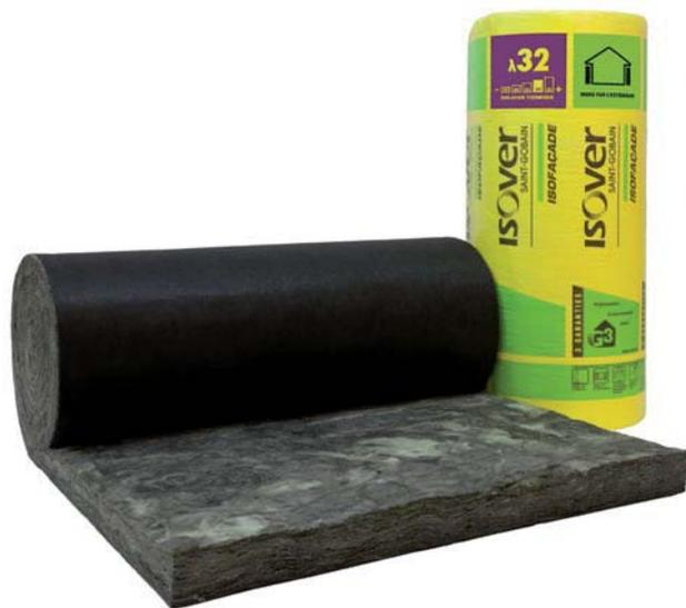
Panneau à dérouler de laine de verre noire semi-rigide revêtu d'un voile de verre pour l'isolation thermo-acoustique des murs par l'extérieur avec des bardages ajourés ou translucides.
