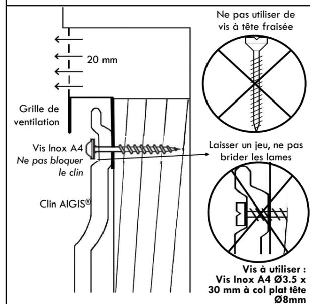
**Egalement disponibles :** Bandes de départ, grilles anti-rongeurs, moulures de joint, Vis Inox A4 col plat tête Ø 8 mm, Ø 3.5 mm, longueur 30mm
