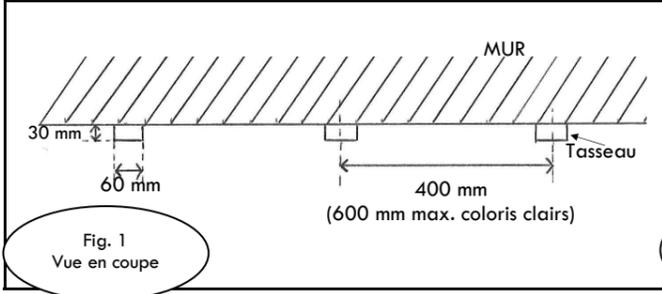
**Pose horizontale sur COB Ossature verticale simple réseau**
