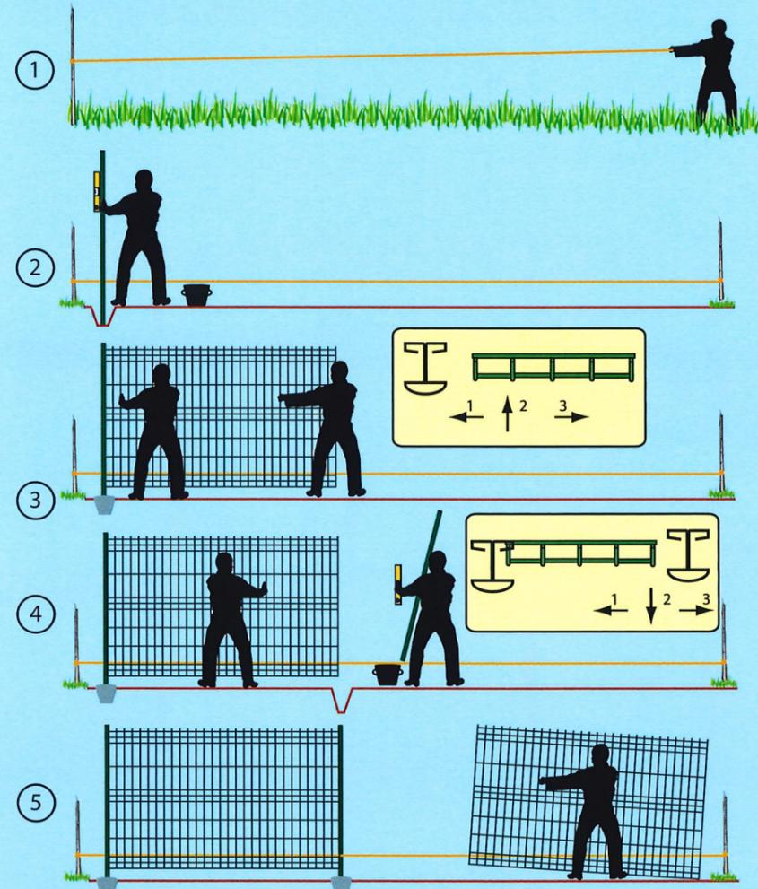
1) Mesurez et préparez le terrain où la clôture sera posée. Posez les poteaux et tendez un cordeau afin d'aligner parfaitement les poteaux.
