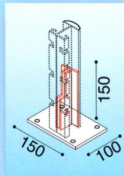
**Les poteaux TITAN en hauteur supérieure à 1,5 m sont déconseillés en montage sur platine**
