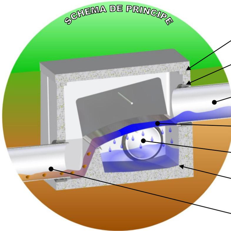
Etanchéité de la rehausse Ht. 200 mm et du couvercle Ep. 25 mm à assurer sur site (Joints IGAS® profilés SIKA® Ø9,5)
