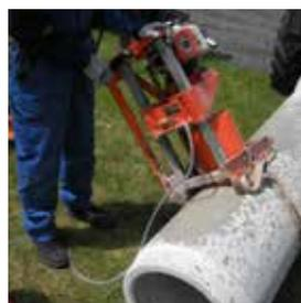
Positionnement correct de la carotteuse.
