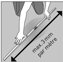
Pure Click peut être installé sur du béton, du carrelage, du bois, et la plupart des revêtements de sol à surface dure, pour autant que la surface existante soit lisse, sèche et propre.
