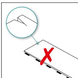
Pure Click ne convient pas pour une utilisation à l'extérieur, dans des solariums ou les saunas. Évitez l'exposition de longue durée à la lumière directe du soleil. Une exposition extrême au soleil, à la chaleur et des changements de température importants peuvent provoquer des dégâts.
