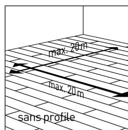
Mesurez la pièce afin d'obtenir un agencement équilibré. En mesurant, vous pourrez déterminer si la première rangée a besoin d'être recoupée. La première et la dernière rangée doivent avoir une largeur de minimum 5 cm.
