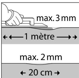
Assurez-vous que l'écart de planéité maximum du sol soit de 3 mm par m et 2 mm par 20 cm. Si l'écart indiqué est dépassé, le support doit être égalisé avec un enduit adéquat ou une couche de nivellement; vérifiez si un produit d'étanchéité est nécessaire.
