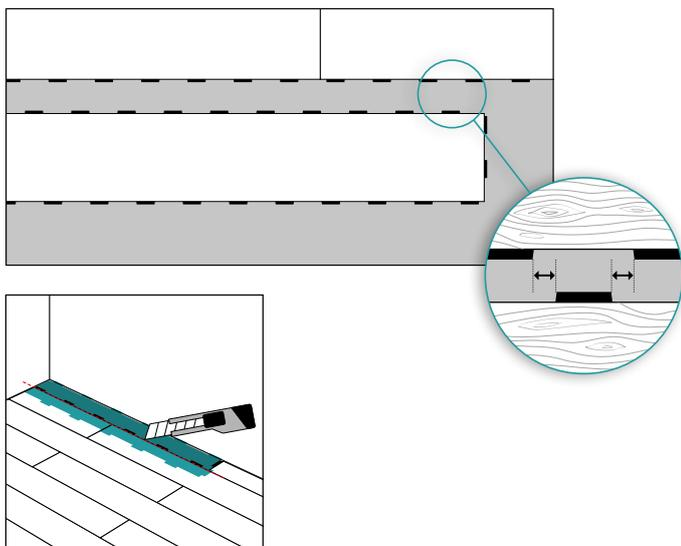
Les clips de la nouvelle rangée doivent être positionnés exactement au milieu des deux dispositifs de verrouillage de la rangée précédente.
