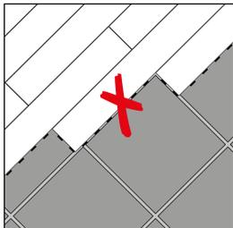
Ne pas superposer les joints des lames du Pure Click, sur les joints du carrelage existant.
